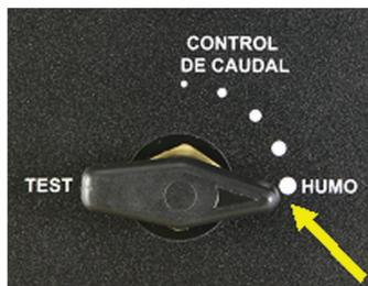
Sencillo sistema de funcionamiento de la mquina de humo, conectar la Batera y pulsar el interruptor. De esta forma, la mquina de humo se convierte en una potente herramienta de medicin completamente adaptable y precisa. Adems, la lmpara halgena de 12V le permitir visualizar rpidamente el humo saliente de un sistema determinado. El caudal de humo es denso.
